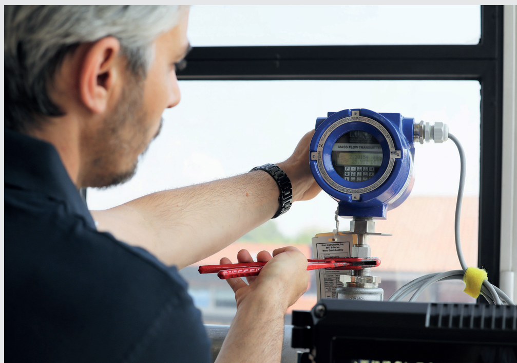
Il misuratore massico termico Kurz 454 è disponibile per tubazioni da 65 mm e oltre. The Kurz 454 thermal mass flow meter is available for pipes 65 mm and larger.
