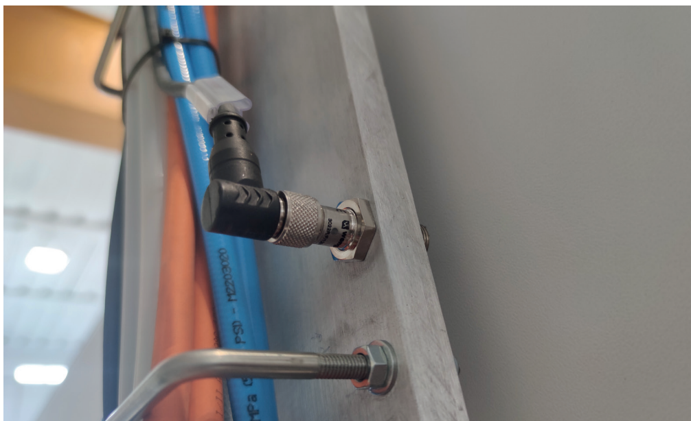
Sensore induttivo: non si usura, è a tenuta stagna e resiste a sporco e vibrazioni. Inductive sensor: wear-free, watertight and resistant to dirt and vibrations.
