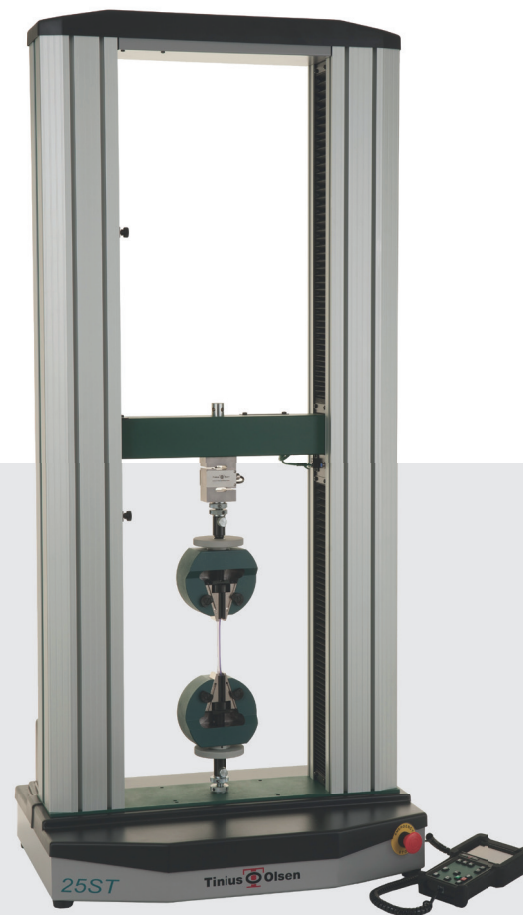
Macchina per prove elettromeccaniche di Tinius Olsen, modello UTM 25KN, proposto da URAI.
