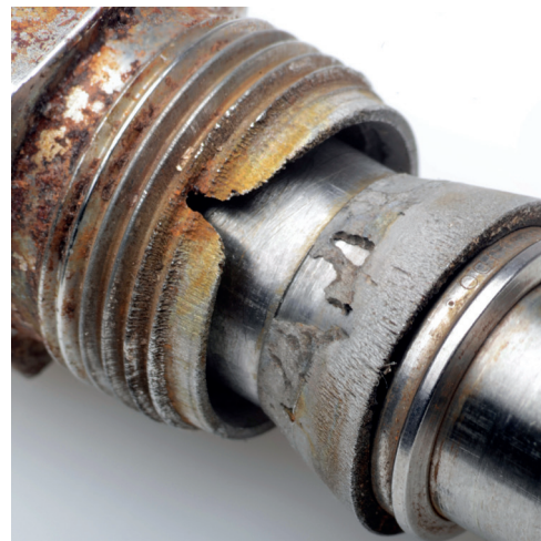
La rottura in un raccordo in acciaio 316 con il tubo in acciaio 6Mo.
