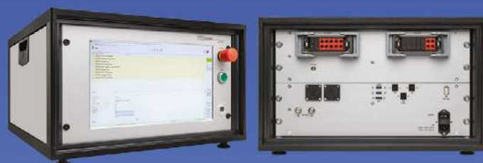
Tester per prove di Surge e Scariche Parziali su motori elettrici
