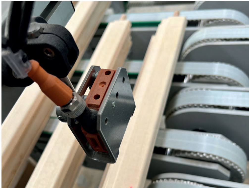
All'interno della linea sono inserite numerose fotocellule O5D100. Numerous O5D100 photocells are integrated into the line.
