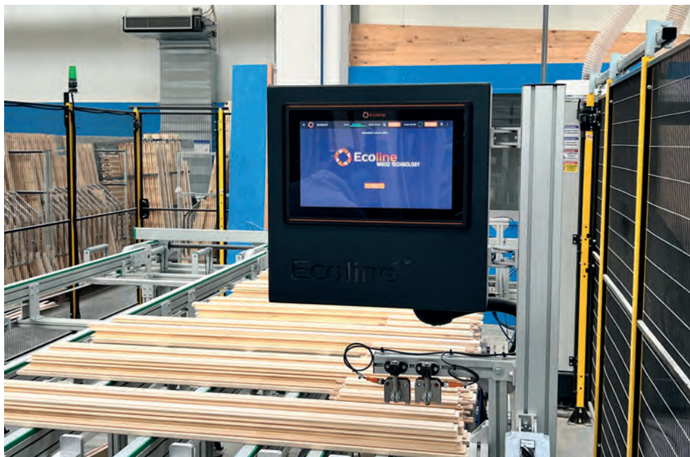
Due piccoli tasti permettono di regolare le fotocellule dal display in pochi secondi. Two small buttons allow the photocells to be adjusted from the display within seconds.
