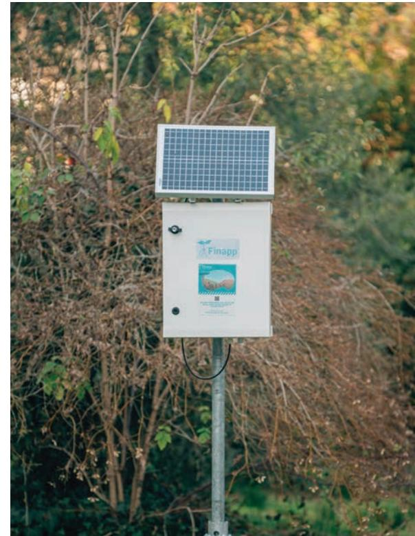
La sonda Finapp usa la tecnologia CRNS per misurare l'umidità del suolo e la SWE.
