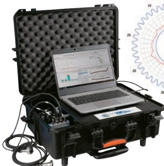
Strumentazione portatile per misure in sala prove, in campo o su veicolo
