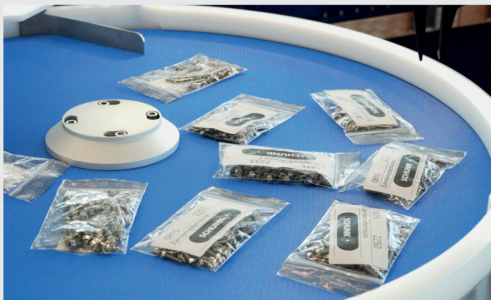
Il sistema rileva e gestisce componenti difficili come viti confezionate in sacchetti di plastica. The system detects and handles difficult components such as screws packed in plastic bags.
