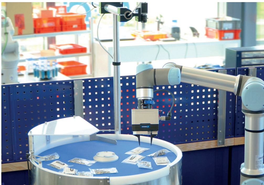
Il 2D Grasping kit solleva i lavoratori da compiti monotoni come lo smistamento di oggetti. The 2D Grasping-Kit relieves workers of monotonous tasks such as sorting of objects.
