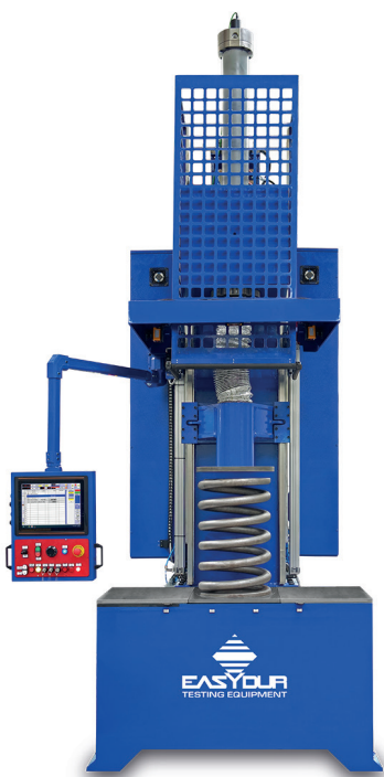
La macchina di prova per la caratterizzazione delle molle di Easydur.
