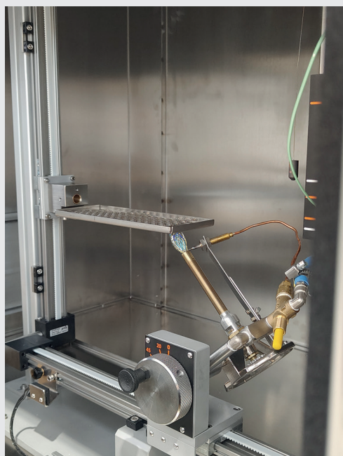
Cabina UL94 per infiammabilità dei materiali, applica sistemi a binario per la regolazione (Noslalabs Ats).
