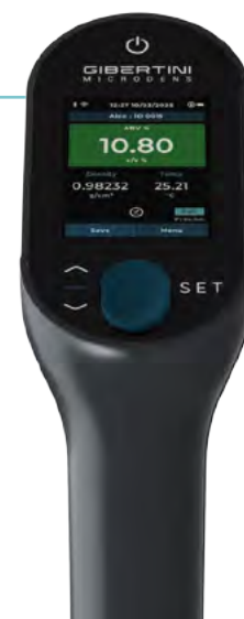
MicroDens, il densimetro digitale portatile di Gibertini Elettronica.
