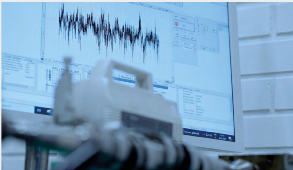
Misurazione della rugosità superficiale con Surftest SJ-500P di Mitutoyo. Surface roughness measurement using the Mitutoyo Surftest SJ-500P.
