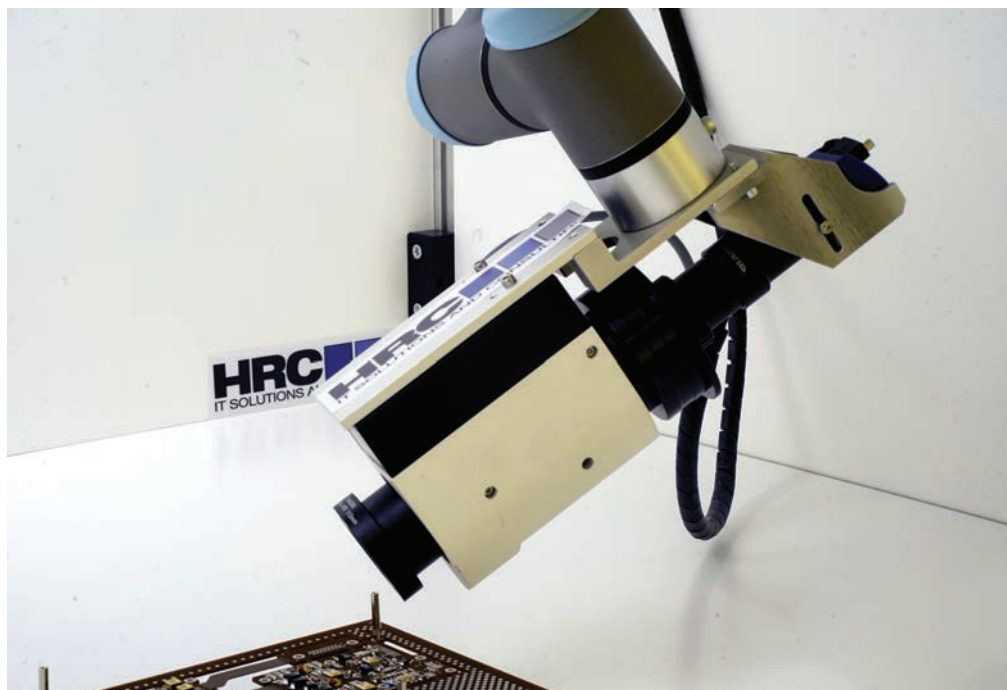
Il cobot ha una camera alla sua estremità, che coglie gli aspetti della scheda da analizzare. The cobot has a camera placed at its end, that captures the card's aspects to be analysed.
