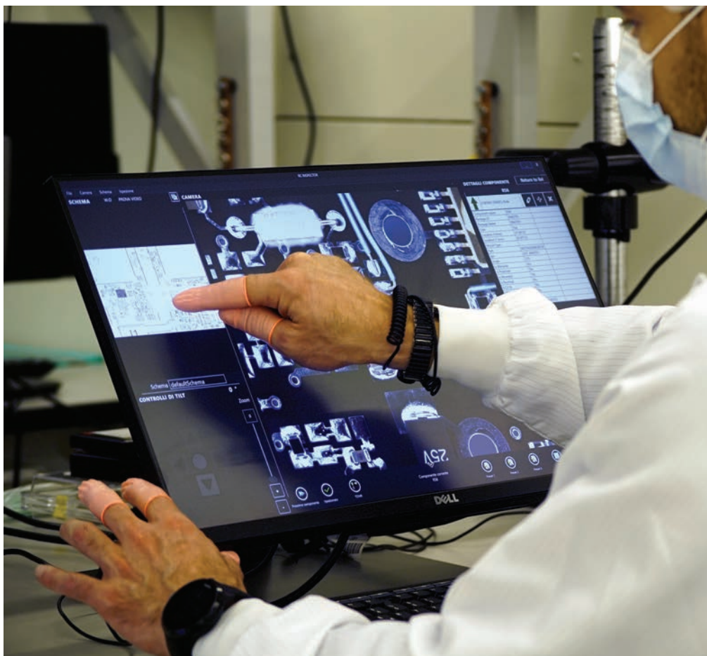
Su uno stesso schermo, l'ispettore ha sia l'oggetto ispezionato che il progetto di riferimento. The inspector has both the inspected object and the reference project on the same screen.
