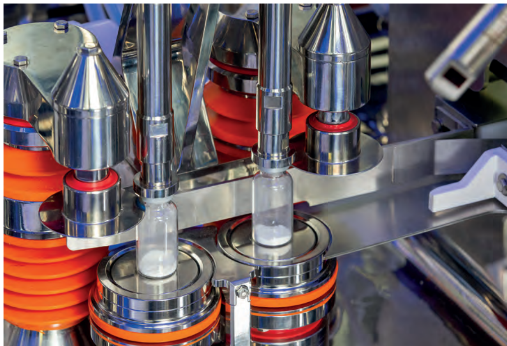
La tappatura dei flaconi di vetro sulla macchina MicroRobot 50. Capping glass bottles on the MicroRobot 50 machine.
