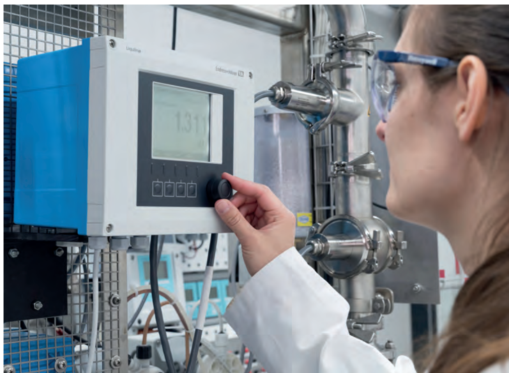
Fotometro di processo e trasmettitore multicanale Liquiline CM44P. Process photometer and Liquiline CM44P multi-channel transmitter.
