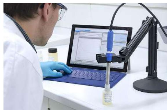
Installate il sensore pretarato Memosens COS81D nel vostro processo e sarà immediatamente pronto per il batch successivo.
