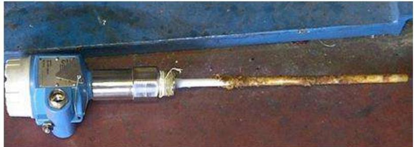
Leveflex FMP51 è in grado di monitorare lo sporcamento dell'asta mettendolo in relazione con l'ampiezza dell'eco riflessa: ad asta pulita il segnale eco era di circa. 35 mV, mentre decresceva man mano che i depositi si fissavano sull'asta. Ad un valore di 8...10 mV il radar andava in allarme per mancanza di eco. Abbiamo impostato una soglia cautelativa di 15 mV sull'ampiezza dell'eco. Valore al quale lo strumento è ancora perfettamente funzionante, ma vicino al valore minimo raggiungibile.
