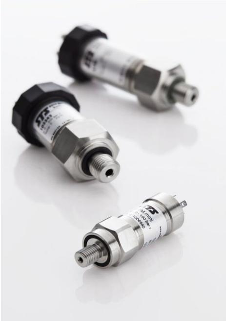
Nelle schede tecniche dei sensori di pressione i produttori segnalano anche la stabilità a lungo termine. Si tratta di un valore ottenuto in condizioni di laboratorio che indica la massima variazione tra il punto zero e l'intervallo di uscita. Questo valore è espresso in percentuale e si riferisce solitamente all'errore totale. Segnala che l'errore totale di un sensore di pressione dopo un anno può peggiorare, ad esempio, dello 0,1 per cento del fondoscala.
